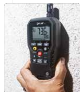
Le FLIR MR77 possède un capteur d'humidité sans pointe et une sonde à pointe avec fil.
